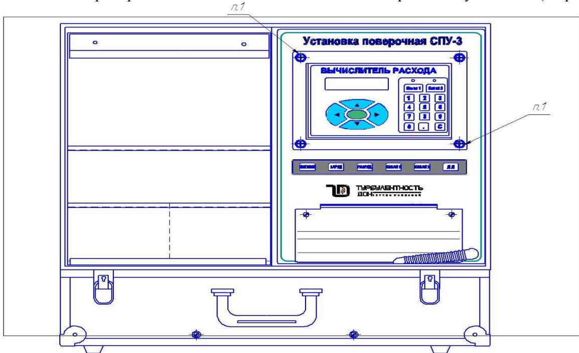
Рисунок 2 - Схема пломбирования вычислителя расхода установок
